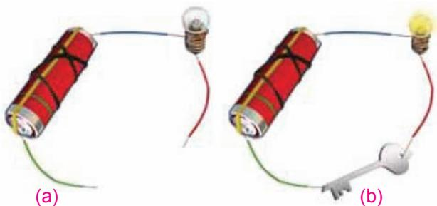
चित्र 7.2 (a) खुले तारों वाला परिपथ (b) चाबी लगा परिपथ
